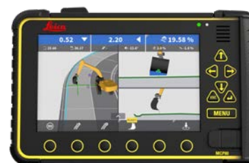
Køreskærm til gravemaskine med svingbom
